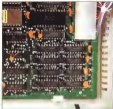
Dietro il coperchio dell'altavox e sotto la RAM del PC, una memoria di tipo per un totale di 64 Kbyte disponibili di questi solo 32 sono accessibili dal BASIC Microsoft e di precisione.
